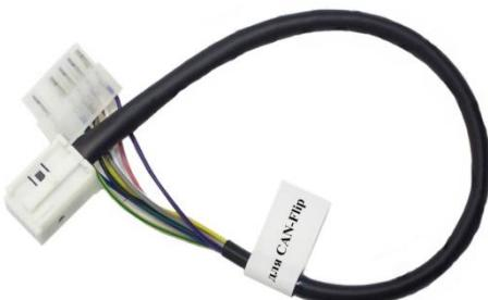
Рис.2. Переходник MiniFit-Peugeot
